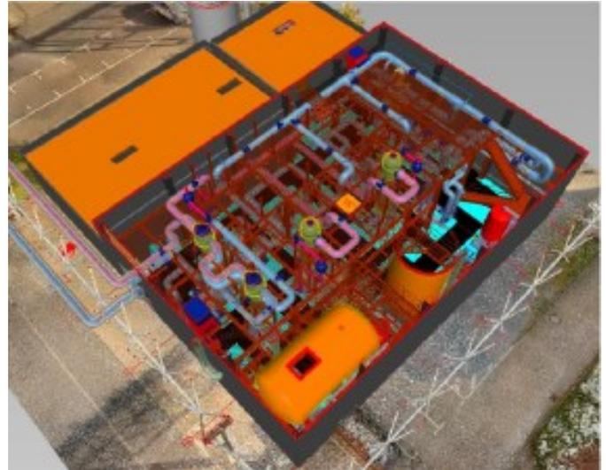
*3D-Modell der neuen Energiezentrale mit vier Wärmetauschern, die die Abwärme sowie Wärme aus einer Kraft-Wärme-Kopplung vom Henkel-Werk in das Fernwärmenetz einspeisen.*
