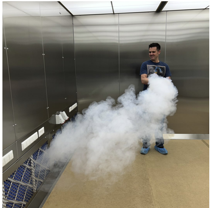
Staubsimulation zur Prüfung der Absaugung / Dust simulation for testing the extraction system
