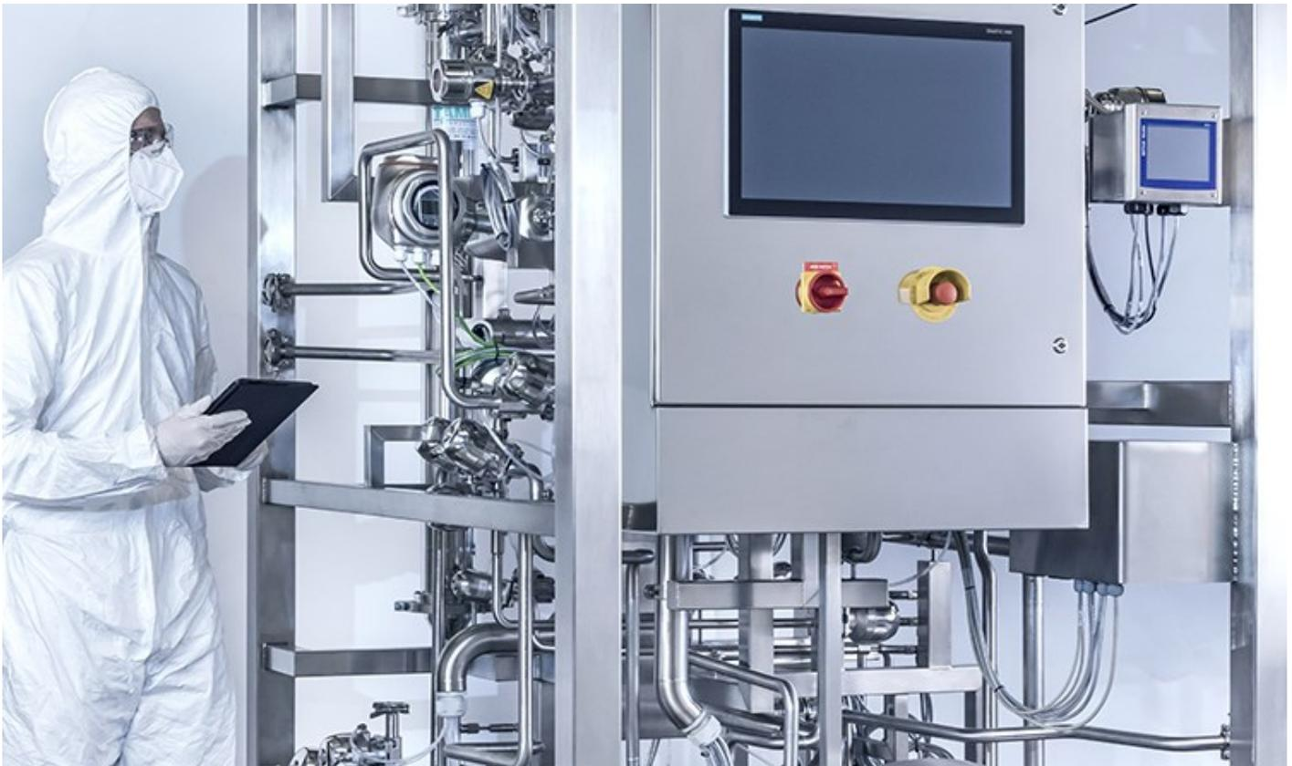
Ein Hersteller von veterinärmedizinischen Produkten beauftragte ZETA mit dem Bau mehrerer Reinigungsskids und deren Integration in den bestehenden Produktionsstandort in Großbritannien. Mit dem Fortschreiten des Projekts erweiterte sich der Lieferumfang auf eine vollständige Erneuerung der gesamten Downstream-Suite und umfasste eine Revision der Boden- und Gebäudeinfrastruktur sowie eine Aufrüstung der HLK- und Reinraumsysteme.
