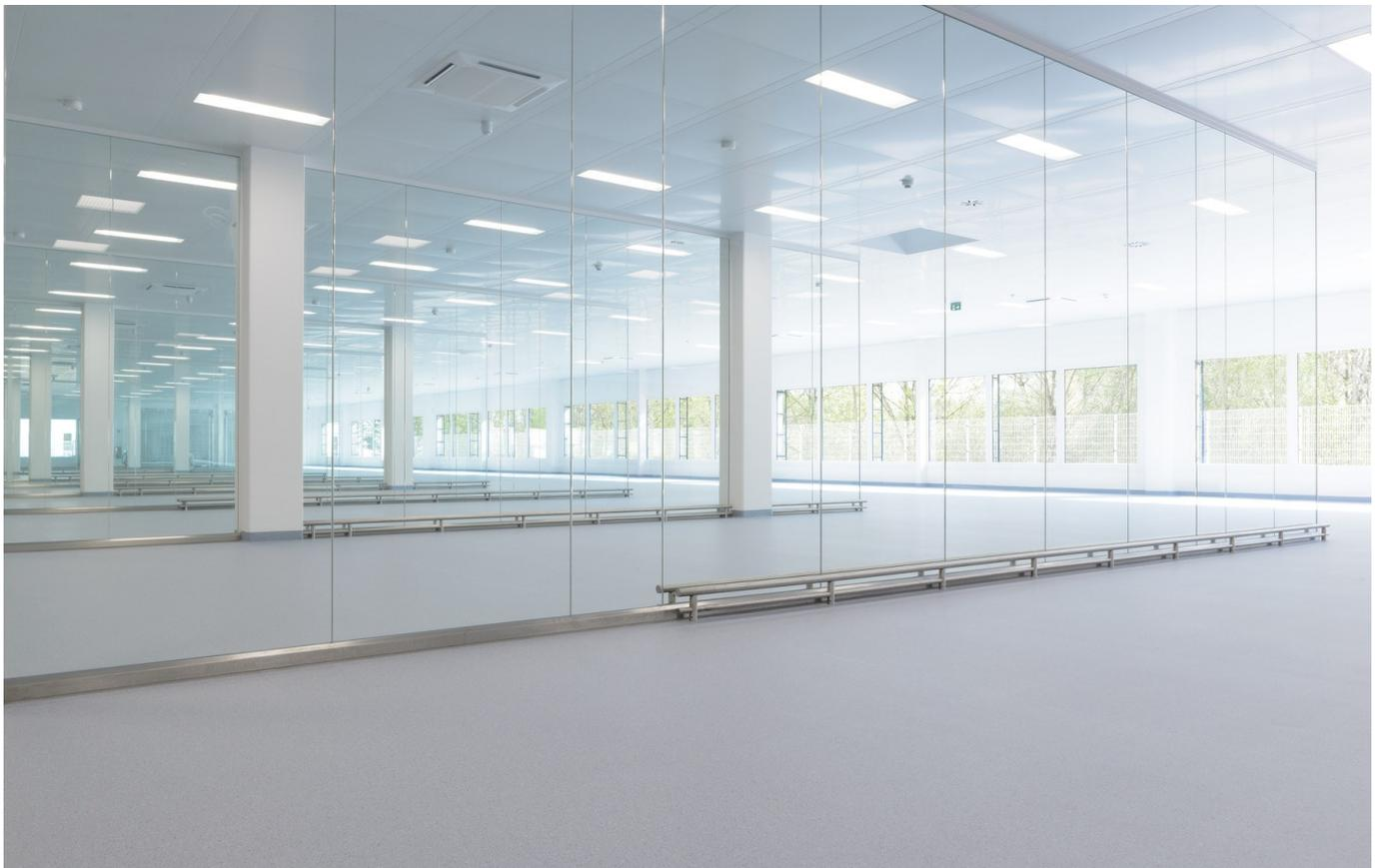
*Im Reinraum-Bereich gelten strengste Hygieneanforderungen – daher erwies sich der Objektbelag Mipolam Biocontrol als ideale Lösung. Stringent hygiene requirements apply in the cleanroom area, which is why the commercial flooring Mipolam Biocontrol presented the ideal solution.*
