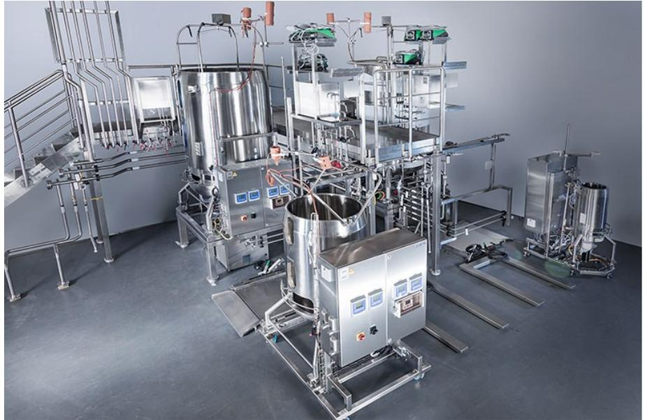
*Edelstahlplattform für die Integration von vier SU-Bioreaktoren (50 L, 500 L, 2x 2000 L).*
