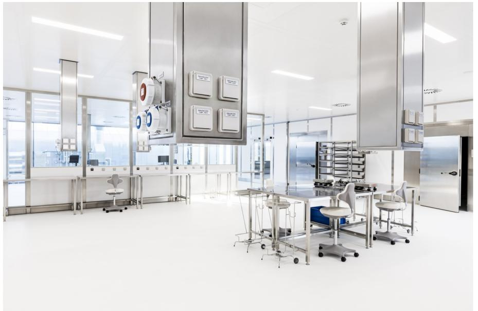
An mehreren Stellen schließt das Wandsystem außerdem direkt an die Gefriertrockner an, die in die Labowände integriert sind. Darin werden die wertvollen Rohstoffe für die Verarbeitung getrocknet.
