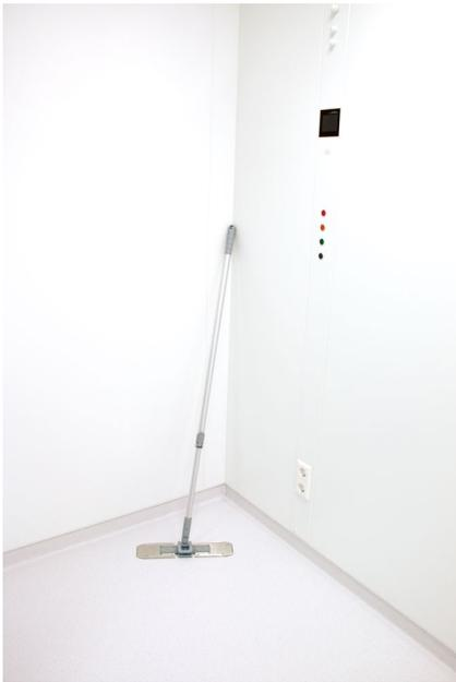
*Abb.3: Mopphalter lehnt ungesichert im Reinraum in einer Ecke und hat Bodenkontakt, welcher streng vermieden werden sollte*
