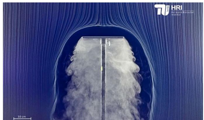
Abb. 1b: Visualisierung einer umströmten Platte per Experiment. Unterhalb der Platte wird Nebel eingebracht, während die Strömung von oben mittels eines Rauchdrahts sichtbar gemacht wird.
