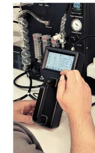
Das Produktangebot der Hersteller ParticlesPlus und Airy Technology reicht von mobilen Partikelzählern über Remote- bis hin zu Handheld-Geräten. Gemessen werden können Partikelgrößen von  $0.3\mu\text{m}$ - $30\mu\text{m}$ , wobei je nach Anforderungen des Kunden das entsprechende Modell zum Einsatz kommt.
