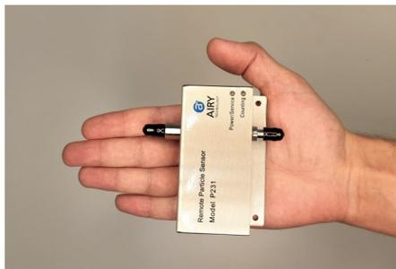
onsräumen, wo auf engstem Raum ein komplettes Monitoring installiert werden muss, sind diese Remote-Partikelzähler ein klarer Pluspunkt.
