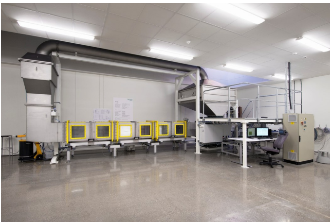
Camfil Tech Center in Trosa/Schweden mit dem Filterteststand für die neue Norm ISO 16890
