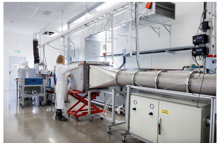
Camfil Tech Center in Trosa/Schweden mit dem Filterteststand für die neue Norm ISO 16890
