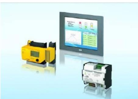
Die Hardware der Lösung basiert auf der bewährten Produktfamilie SAUTER EY-modulo 5 und umfasst unter anderem eine EY-AS-525-Automations- oder eine EY-RC-504-Raum-automationsstation, zwölf DI- und 18 DO-Feldmodule, einen 8-Port-Switch, einen 17"-Touchpanel-PC und eine externe HDD.
